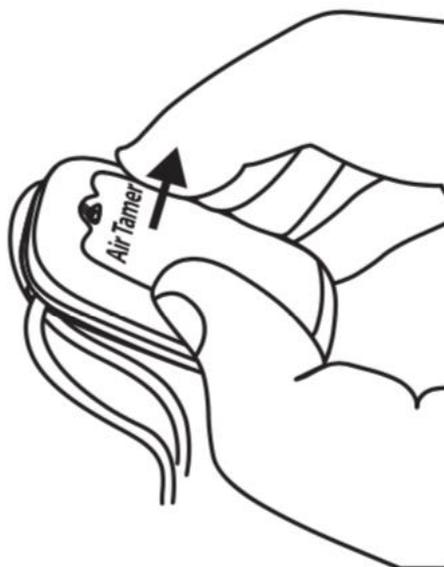
2. Ponga la nueva **CUBIERTA DEL EMISOR DE IONES NEGATIVOS** en la carcasa de su **AirTamer**. La conexión es magnética, de modo que el **EMISOR DE IONES NEGATIVOS** encajará con seguridad en su lugar.
