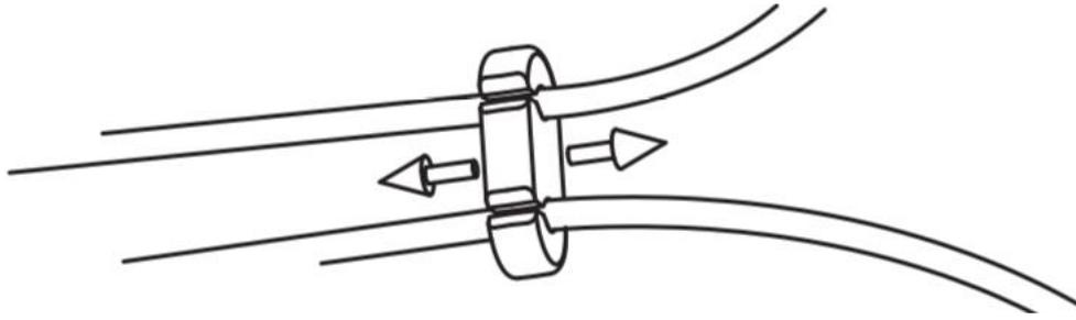
2. Para reemplazar el **CORDON CONDUCTOR** del **AirTamer**, simplemente deslice el cable conductor de la unidad AirTamer hacia abajo. Tenga cuidado de no tirar hacia arriba, ya que podría doblar el clip del bolsillo/camisa.
